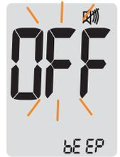
Si el sonido se ha ajustado a OFF, ninguna de las funciones de sonido va a funcionar. Después de Ajustar el sonido pulse el botón **S** para avanzar al siguiente paso.
